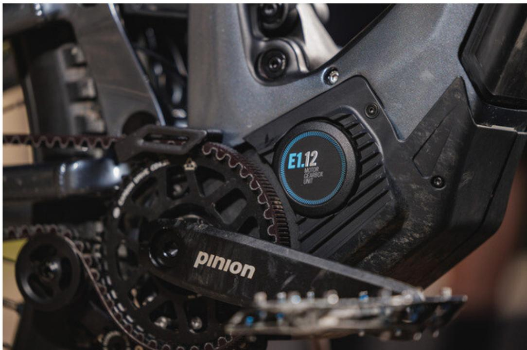
Die PINION MGU vereint einen starken E-Bike-Antrieb mit 12-Gang Tretlager-Getriebe und ungeschlagenen 600 Prozent Bandbreite.
